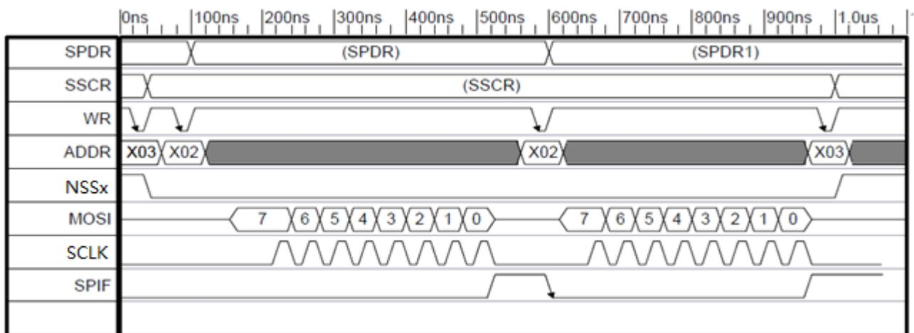
图 17-4: 软件控制 NSSx 线
