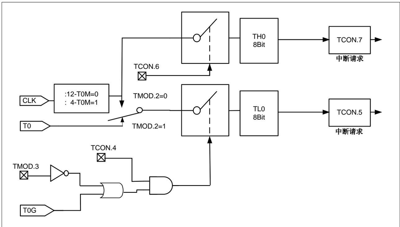
图 8-4: Timer0, 模式 3: 两个 8-位定时/计数器
