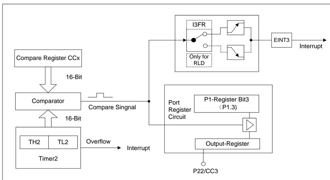
图 9-5: Timer2 比较模式 1 的结构
