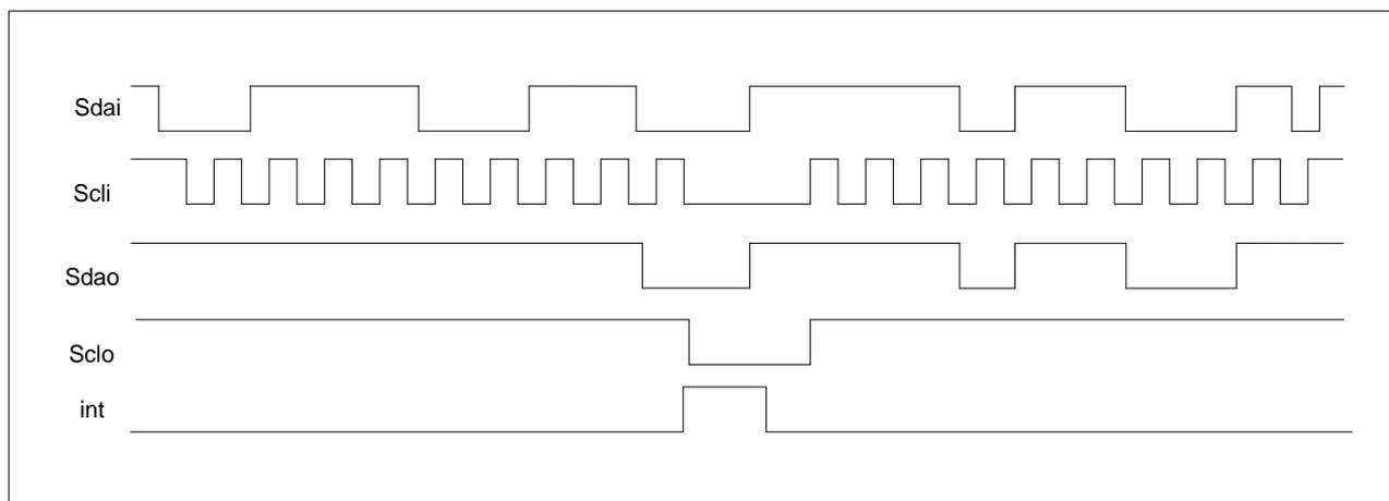
图 14-3: 单次发送操作时序图
