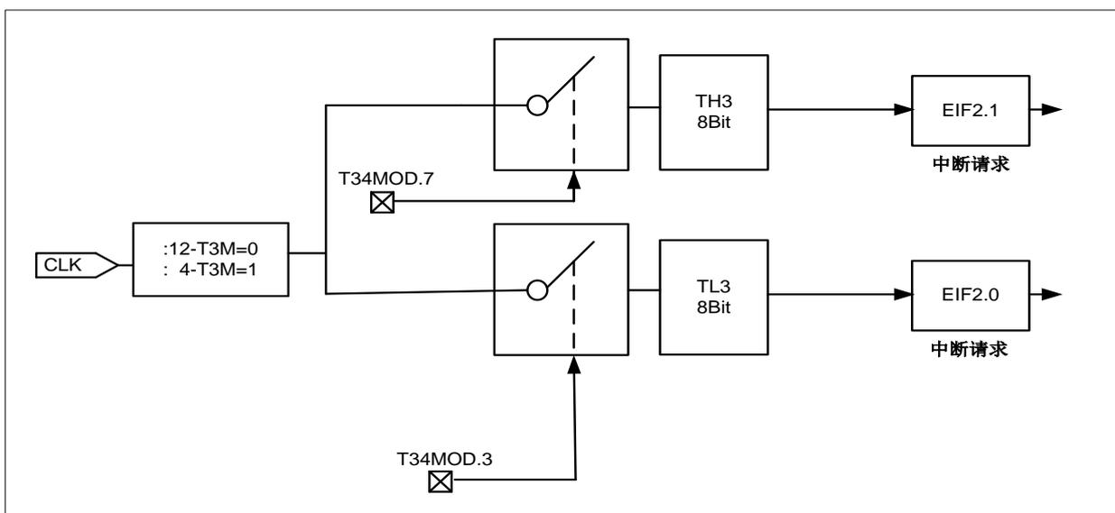
图 10-4: Timer3, 模式 3: 两个 8-位定时/计数器
