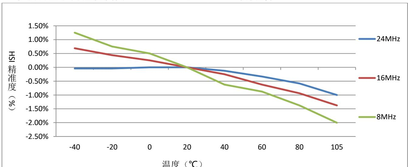
图 23-1: 精度与温度关系曲线
