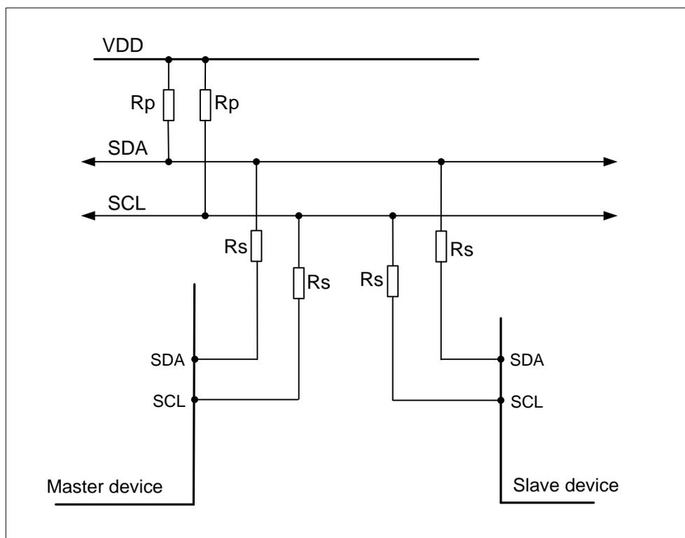
图 14-1: I<sup>2</sup>C 连接图
