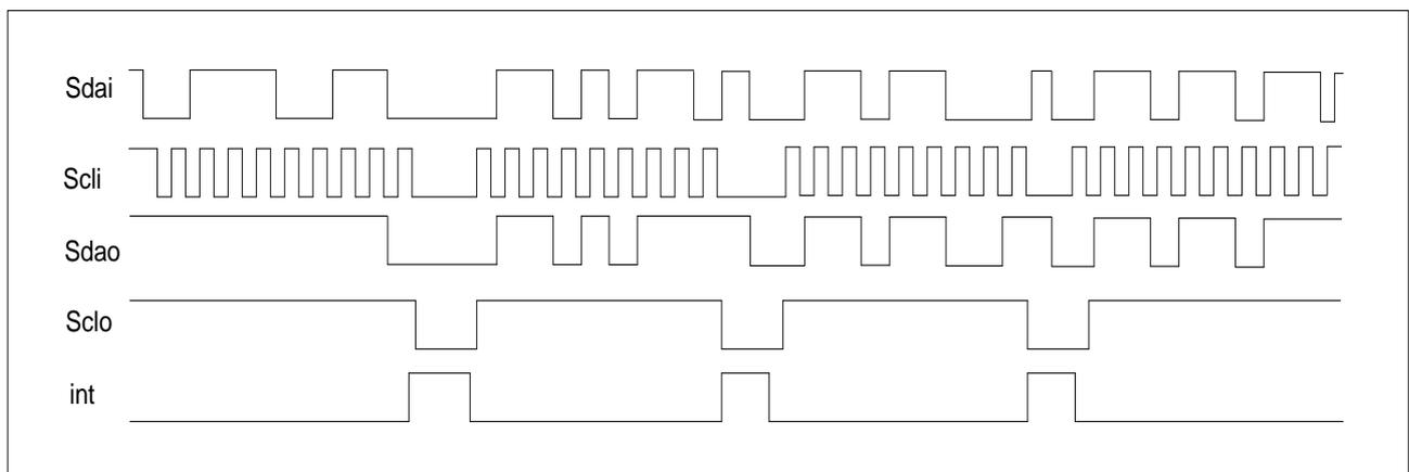
图 14-5: 连续发送操作时序图
