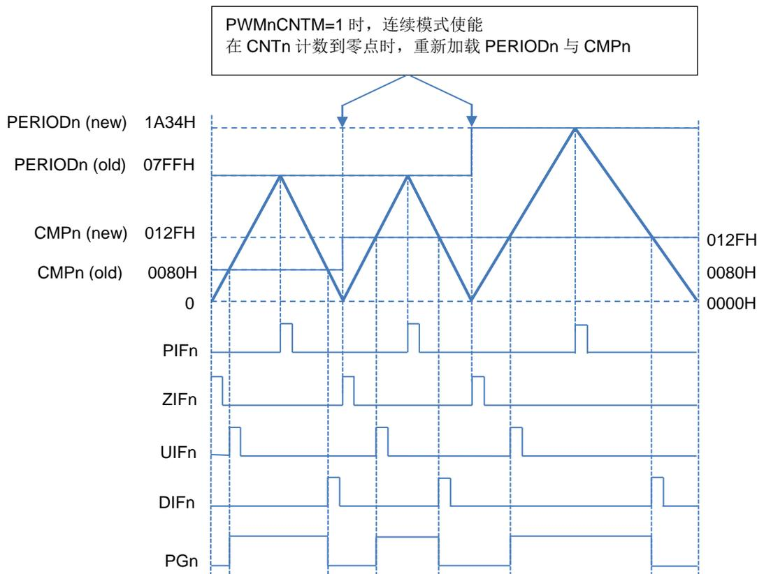
图 13-2: 中心对齐时序图（对称计数）
