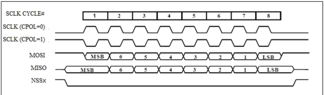
图 17-9: CPHA=1 SPI 传输格式
