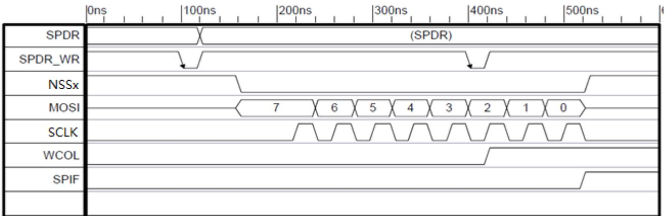
图 17-5: SPI 主模式下的写冲突错误
